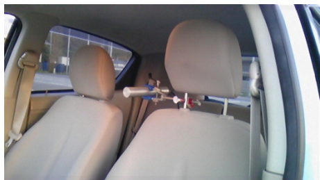
図1 サーベイメータ検出部の固定
