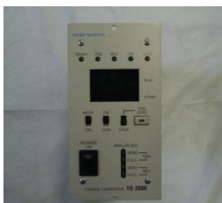
図3-3-2 デジタルトルクメータ
