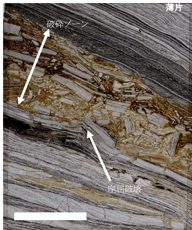
図-3.23 標本④ 泥質片岩内に発達した局所的な破砕ゾーン
