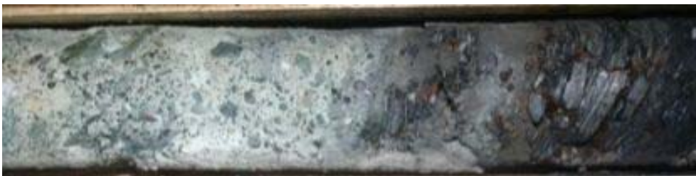
図-2.27 BV-2 すべり面 35.5m 近接写真
