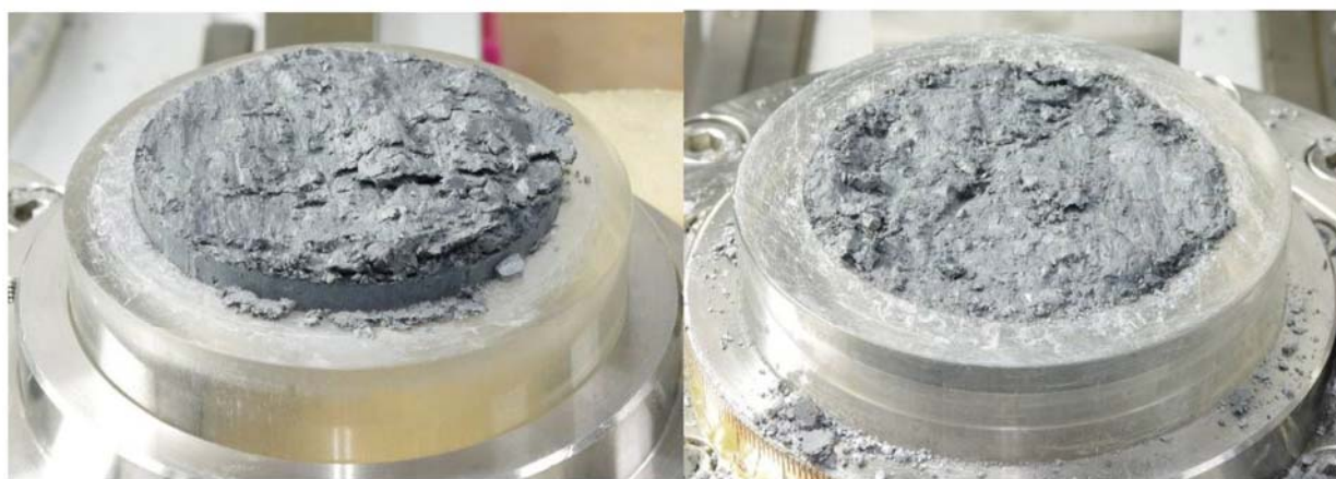
図-2.39 檜尾.2 BV18-5 せん断試験後の試料のせん断面
