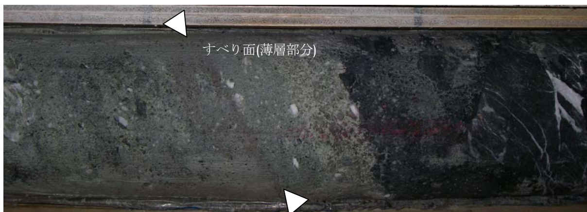
図-4.10 富士の池 BV-1 すべり面接写写真
