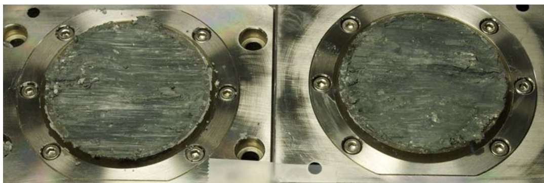
図-2.31 No.2 集水井試料の試験後のせん断面（左：下盤，右：上盤）
