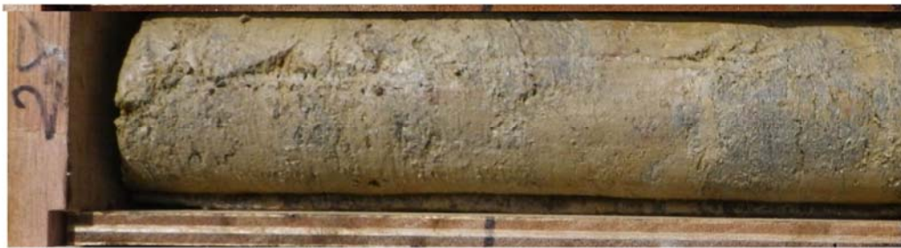
図-3.6 ボーリングコアクリーニング前
