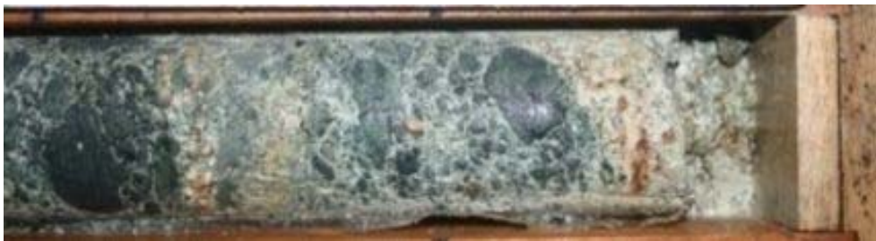
図-2.26 BV-1 すべり面 38.8m 近接写真
