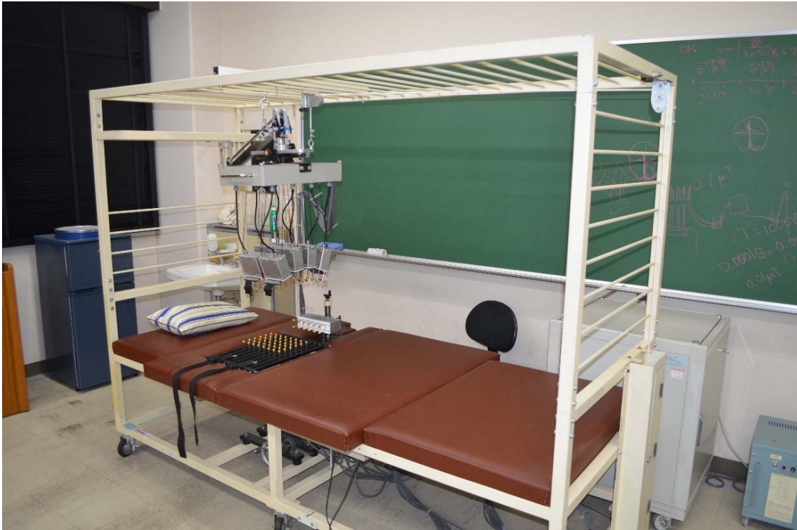
図3-36 試作した体表面心電計の外観写真
