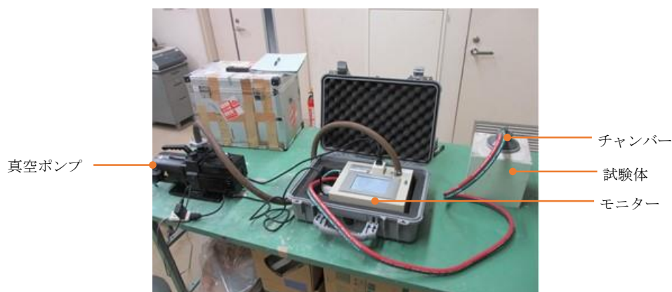
写真 7.5 透気試験の状況
