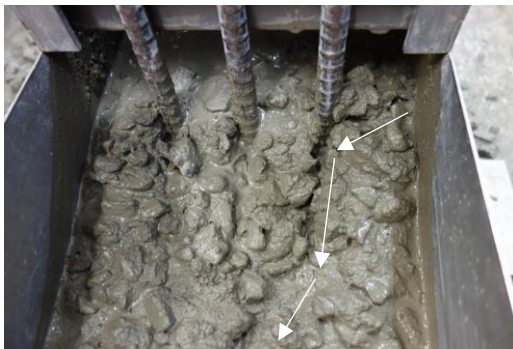
写真 6.2 加振 L フロー試験状況
