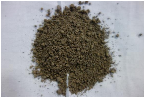
写真 4.1 フェロニッケル細骨材 (FNS5)
