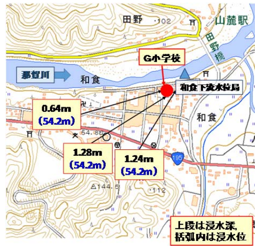
図-6 那賀町G小学校周辺の浸水状況
