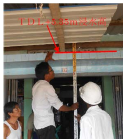
写真-3 浸水高の測量状況
