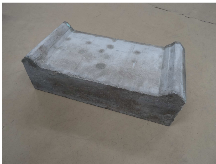
写真 3.16 防水モルタル全体写真
