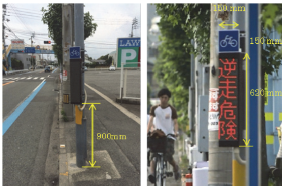
図-2 LED文字警告装置（左：非点灯 右：点灯）
