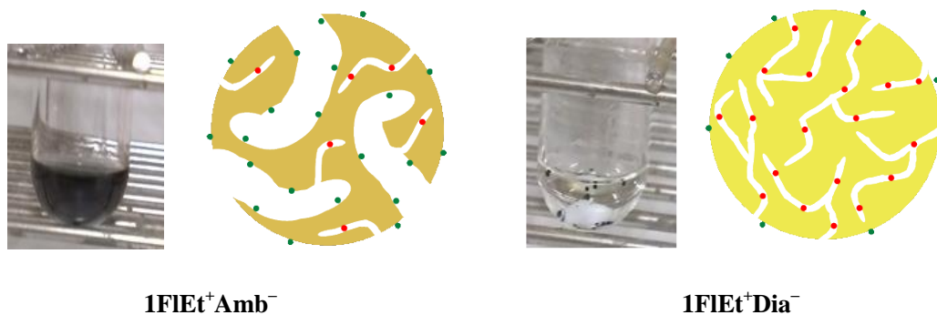
Figure 1. フラビニウムレジン 1Et^+Amb^- および 1Et^+Dia^- を用いた触媒反応における反応溶液の写真と樹脂構造のイメージ図 反応に関与できるフラビン分子を緑 (●), 反応に関与できないフラビン分子を赤 (●) で示した
