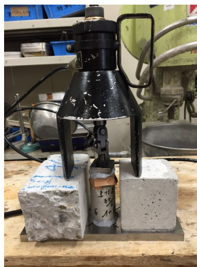
写真 3.3 建研式接着強度試験
