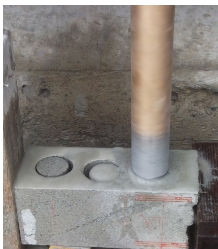
写真 4.10 曲げ強度試験破断供試体からのコア採取状況
