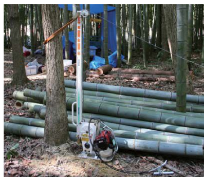
写真 6.1 ポータブルウィンチによる集材の例 51)
