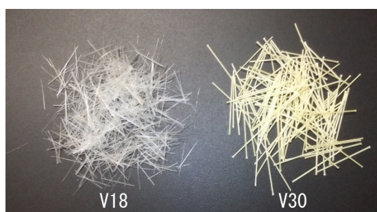
写真 2.3 使用ビニロン繊維の外観
