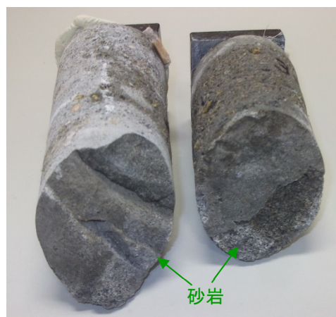
写真 5.9 砂岩剥離破壊 (B+FA)
