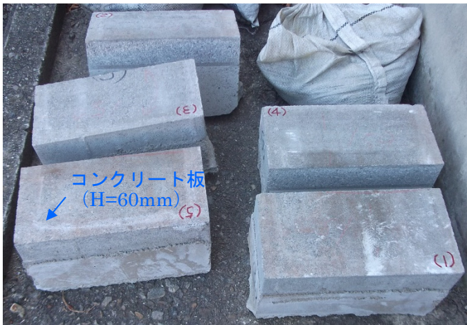
写真 4.7 コンクリート面と吹付けモルタルの接着強度試験供試体
