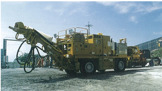
写真 1.6 トンネル吹付けコンクリート工（吹付けロボット） 17)
