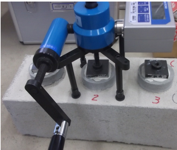
写真 4.8 建研式接着強度試験
