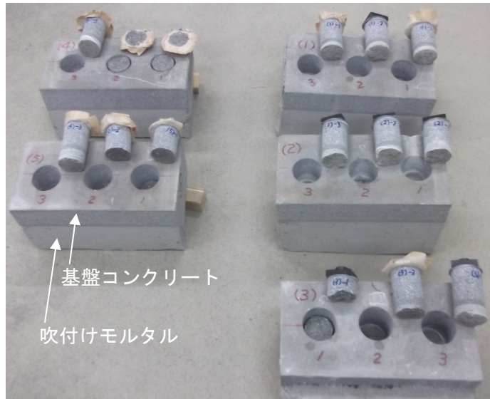
コンクリート面：基盤コンクリートまたは吹付けモルタルの破壊
