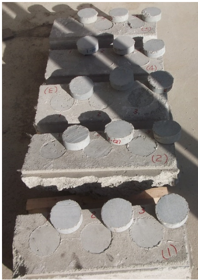
岩石面：接着界面での剥離破壊
