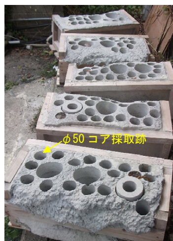
写真 4.11 凍結融解試験モルタルブロックからのコア採取跡
