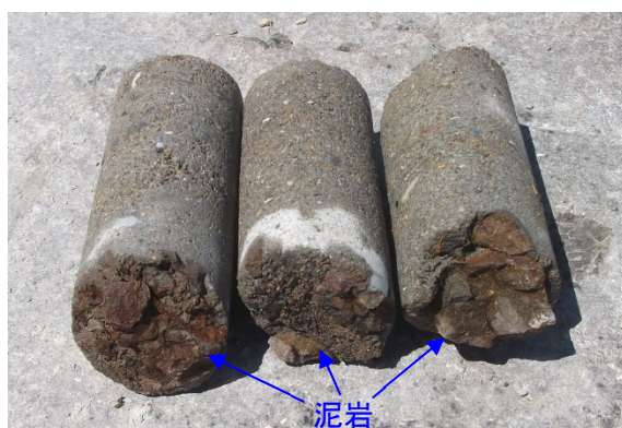
写真 5.11 泥岩部への切込み時に剥離した供試体 (N)
