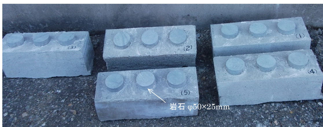
写真 4.6 岩石面と吹付けモルタルの接着強度試験供試体
