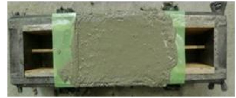
写真 1.13 竹筋引張試験体コンクリート埋込み 39)
