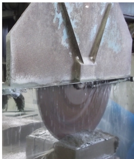
写真 4.5 供試体切出し状況 (曲げ強度試験用)
