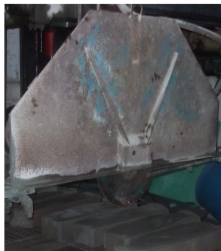
写真 4.5 供試体切出し状況 (曲げ強度試験用)
