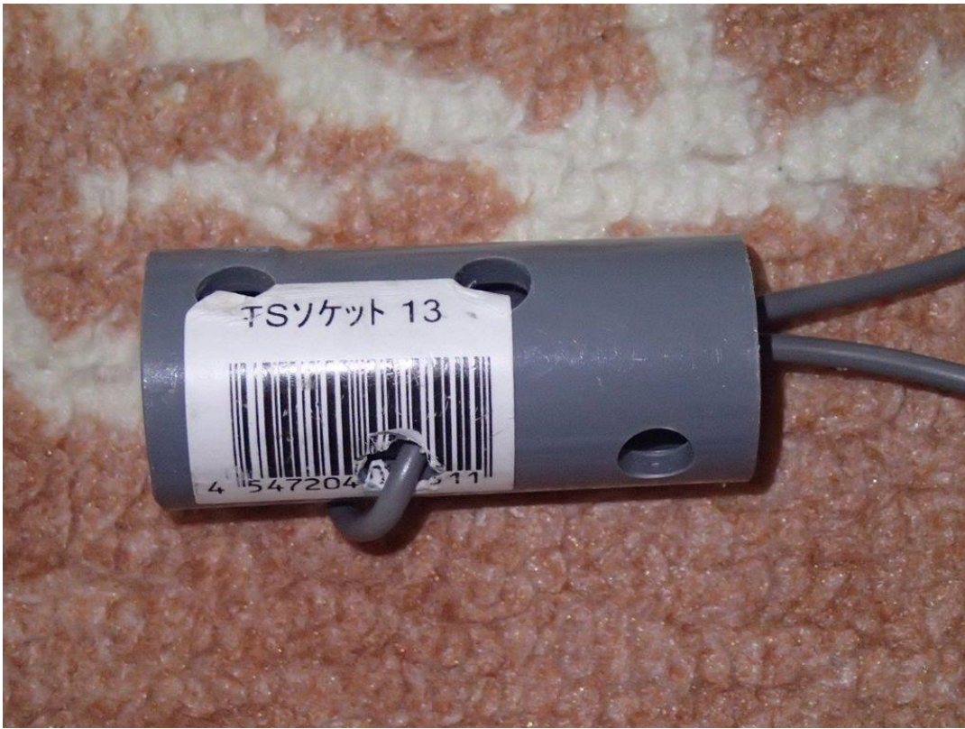
写真4 ソケットを用いた代用碍子
