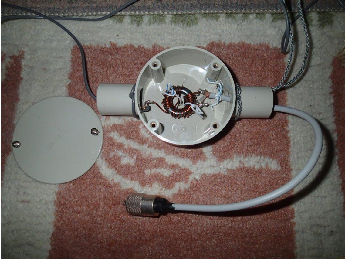
写真1 EFHWs アンテナの給電部と広帯域トランス(FT114-43 27T タップ 4T + 100pF)
