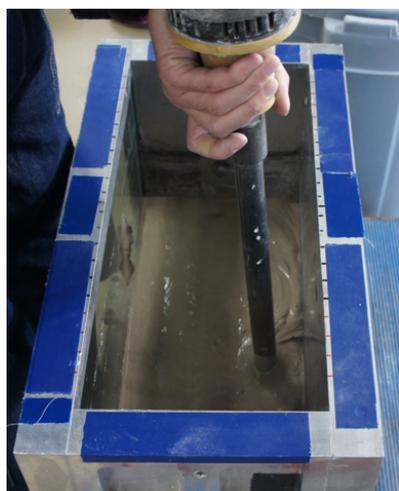
図 2.8 土槽への流し込み
