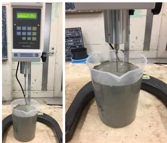
写真4.1 B型粘度計の外観および計測状況
