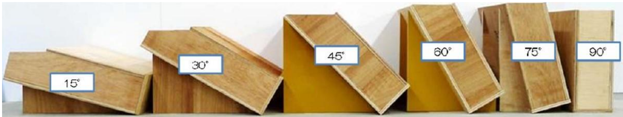
写真 2.6 撥水加工の有無による浮き型枠の勾配
