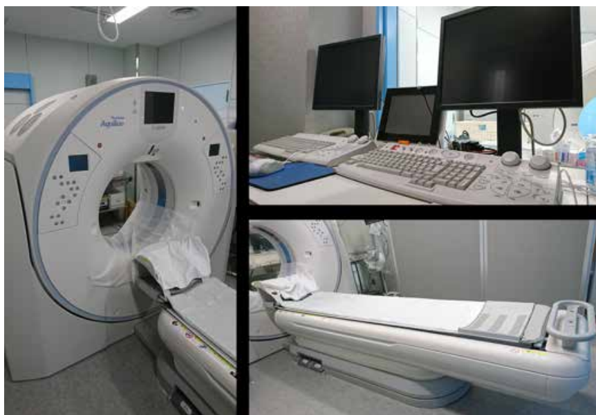
図 1 CT 装置の構成（左：ガントリ（架台）、右上：コンソール（操作卓）、右下：寝台）
