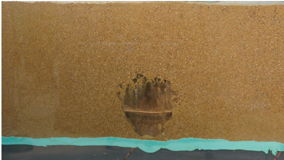
写真-2 発生した空洞と露出したフィーダ線 4)
