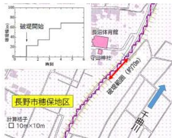
図-3 長野市穂保の破堤箇所の解析方法説明図
