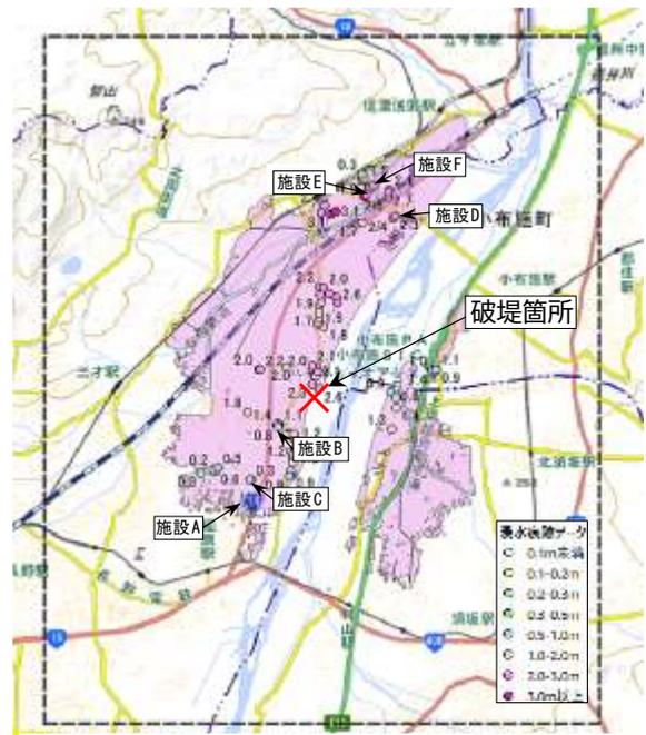
国土地理院洪水推定段階図の浸水範囲に浸水痕跡データを追加。破線の枠で氾濫シミュレーション解析範囲を示す。
