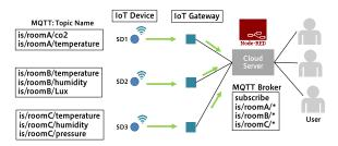
図2 構築した IoT システムの構成
