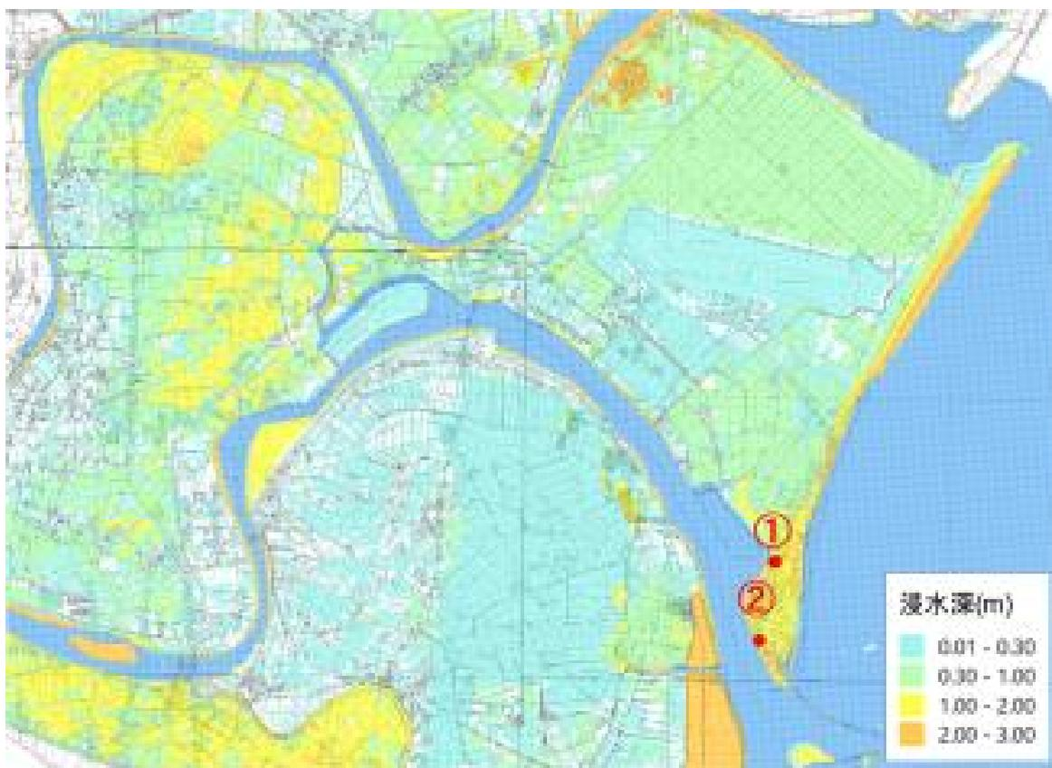
図-3 第二室戸台風当時の松茂町付近の浸水状況の再現結果
