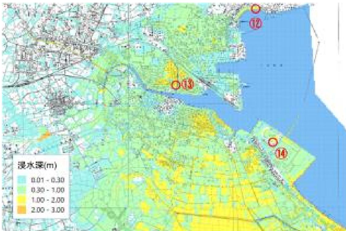
図-6 第二室戸台風当時の小松島市の浸水状況の再現結果
