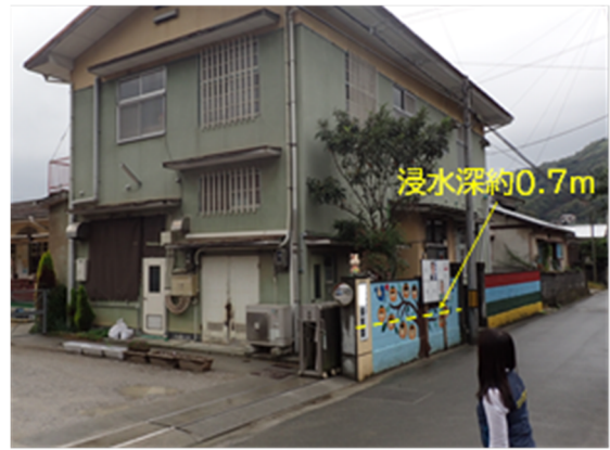
写真-1 U1 保育園 (2018年11月9日撮影写真に市提供の被害状況写真を元に浸水ラインを加筆)
