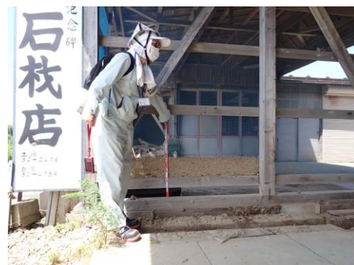
写真-7 堤防上の石材店の金網に付着したゴミ（痕跡高 0.7m）
