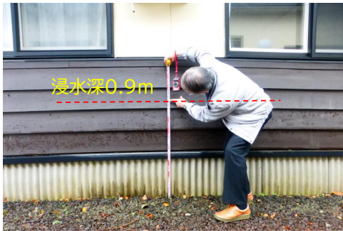
写真-4 高齢者施設②の浸水痕跡（浸水深 0.9m）と近くの民家の浸水痕跡（浸水深 1.4m）
