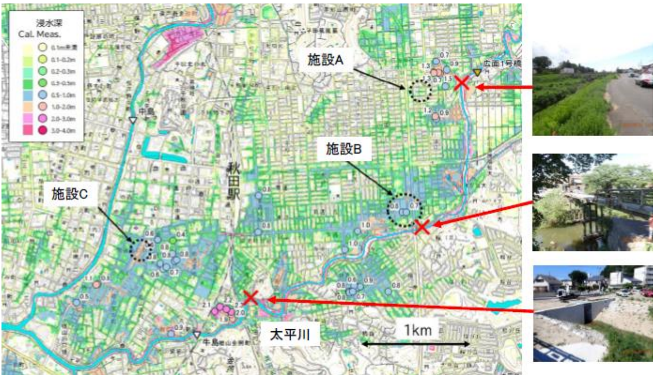
図-3 秋田市にある施設 A,B,C 周辺での最大浸水深の再現計算結果
